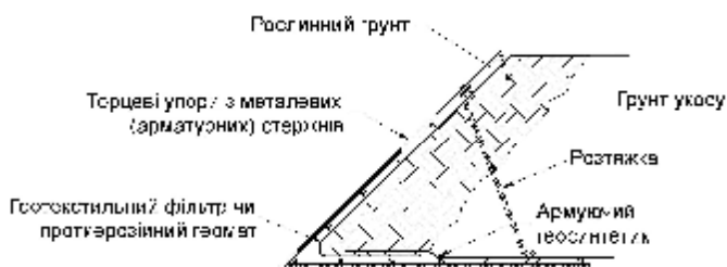
в) деталі нахиленої опалубки
