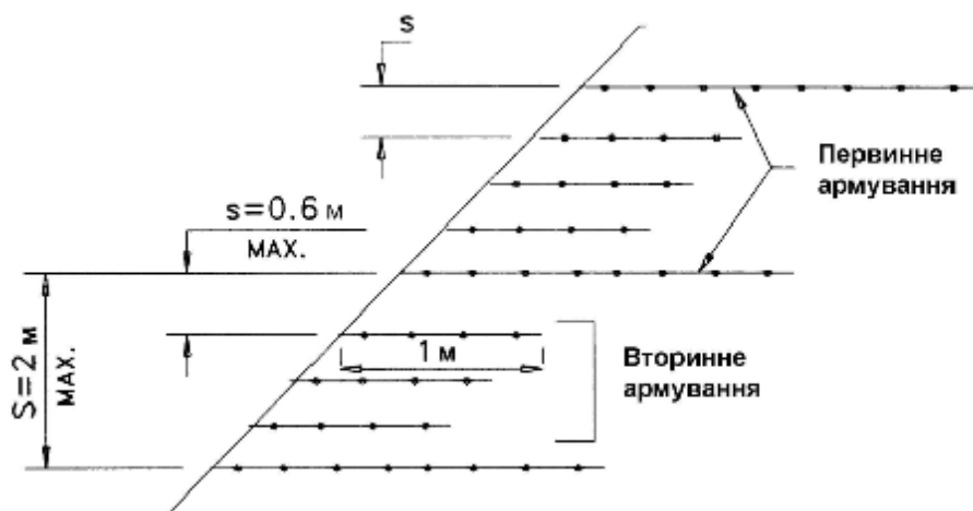
Рисунок 7.4 – Схема закладення полотен вторинного армування між полотнами первинного армування
