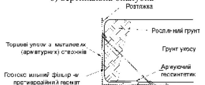
г) деталі вертикальної опалубки
