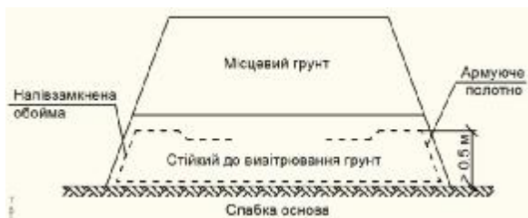
а) одношарове армування насипу напівзамкненою обоймою
