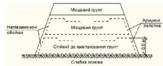
б) багатшарове армування насипу напівзамкненими обоймами
