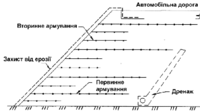
Рисунок 7.1 – Схема армування і стабілізації укосу насипу
