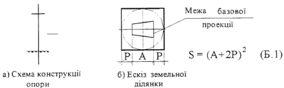
Рисунок Б.1 - Стояк одиночний з трапецієподібним перерізом
