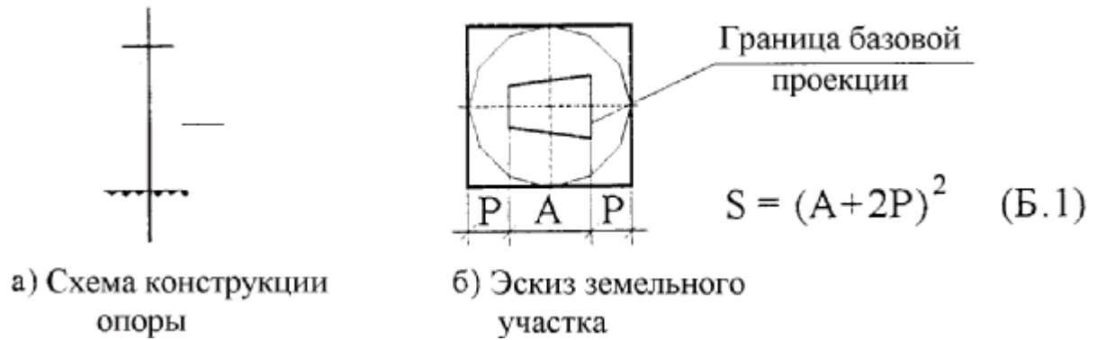
Рисунок Б.1 - Стойка одиночная трапециеобразного сечения
